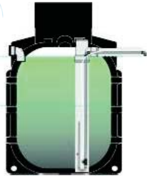
PRVI REZERVOAR vhodna komora
